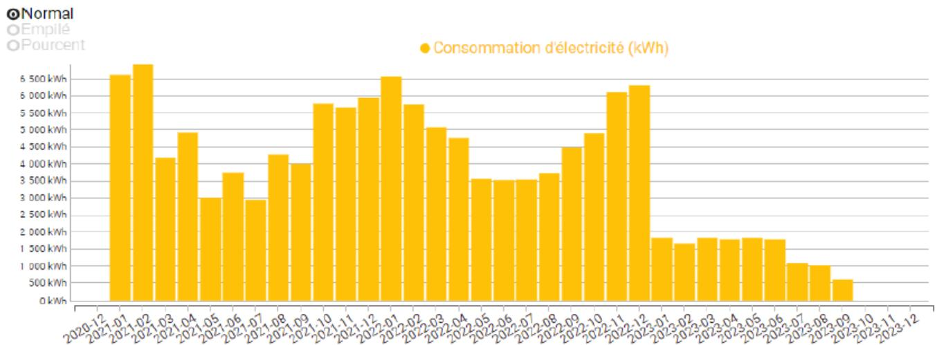
L'installation des horloges de programmation a permis de diviser la consommation en moyenne par 3 sur l'année 2023 comparé aux années précédentes. Malgré l'augmentation importante du prix du kWh en 2023, la facture d'électricité va tout de même être diminuée de 40 %. Fort de ce constat et pour répondre aux exigences gouvernementales en terme de sobriété énergétique, l'extinction partielle de l'éclairage public est donc désormais actée.
